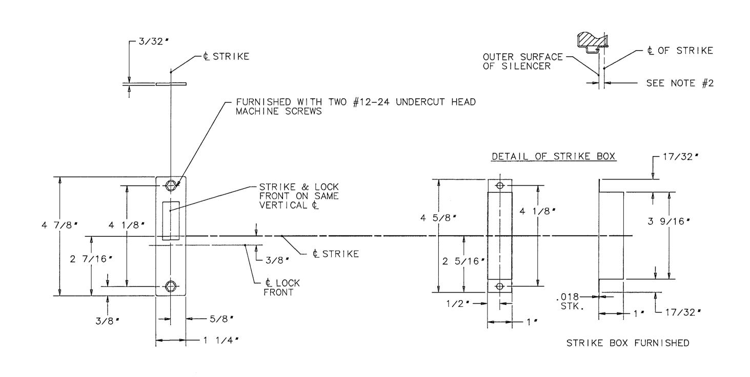
2-WHEN DOOR SILENCERS ARE USED ON DOOR FRAME, LOCATE CENTERLINE OF STRIKE FROM SURFACE OF DOOR SILENCER AS SHOWN.
