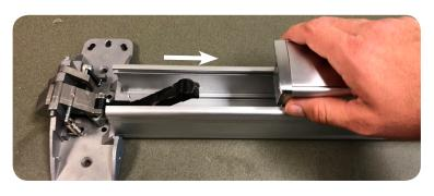
4. PUT THE SWITCH ON THE LEFT SIDE OF THE HEAD AND MAKE SURE THE SWITCH ARM IS UNDERNEATH THE PIN ATTACHED TO THE RIM LATCH
