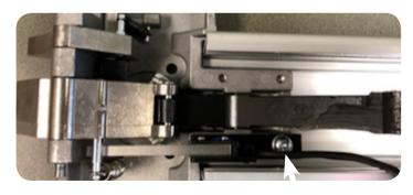
**6.** FISH THE LBM WIRES THROUGH THE BASERAIL TO THE BACK OF THE DEVICE AND SLIDE THE PUSH PAD BACK TO THE CORRECT POSITION.
