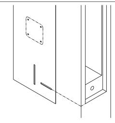
STEP 2) MARK HEIGHT (LEVEL WITH BOTTOM OF FRONT POCKET - AS SHOWN)
