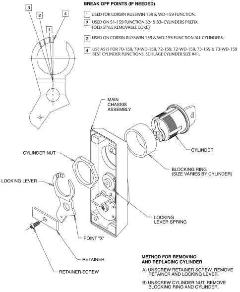
C) REPLACE CYLINDER BY REVERSING PROCEDURES ABOVE. MAKE SURE THAT CYLINDER CAM FACES UP AND THAT LOCKING LEVER SPRING ENGAGES LOCKING LEVER AT POINT "X".
