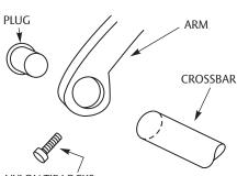
NYLON TIP LOCKS ASSEMBLY IN POSITION WHEN SCREW IS <u>TIGHT</u>
