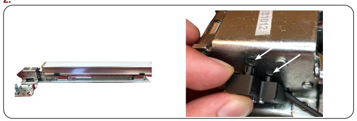
3. RUN THE LBM WIRES DOWN THE PUSH PAD TO THE BACK OF THE DEVICE & SLIDE HOUSING BACK ON KEEPING WIRES IN THE LOWER CHANNEL.
