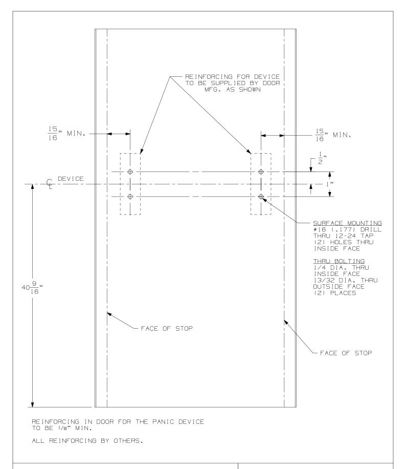
1498 DUMMY DEVICE FOR HOLLOW METAL DOORS
