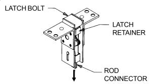
B. PULL DOWN ON THE ROD CONNECTOR AND PUSH UP ON THE LATCH RETAINER. THE LATCH BOLT WILL EXTEND.
