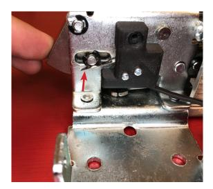
9. PULL WIRE SLACK AND ADD CABLE TIE & STICKY PAD FOR A STRAIN RELIEF. ADD LBM COLOR CODE STICKER
