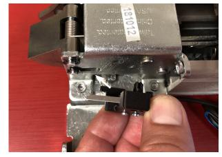
7. CONFIRM SWITCH ARM IS UNDERNEATH RIM LATCH PIN
