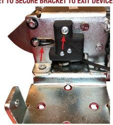
**9.** PULL WIRE SLACK AND ADD CABLE TIE & STICKY PAD FOR A STRAIN RELIEF. ADD LBM COLOR CODE STICKER
