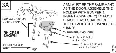
ATTACH DOOR CLOSER TO DOOR WITH SPRING POWER NUT TOWARDS HINGE.
