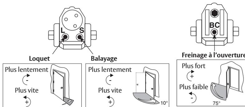
L'A.D.A. stipule qu'à partir d'une position ouverte de 70°, la porte prendra au moins 3 secondes pour se déplacer jusqu'à un point situé à 75mm (3") de la position verrouillée, mesuré à partir du nez de vantail de la porte.
