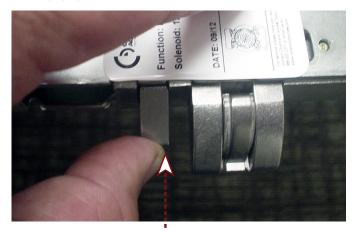
PULL SLACK OUT OF THE SWITCH WIRES AND INSTALL STRAIN RELIEF.
