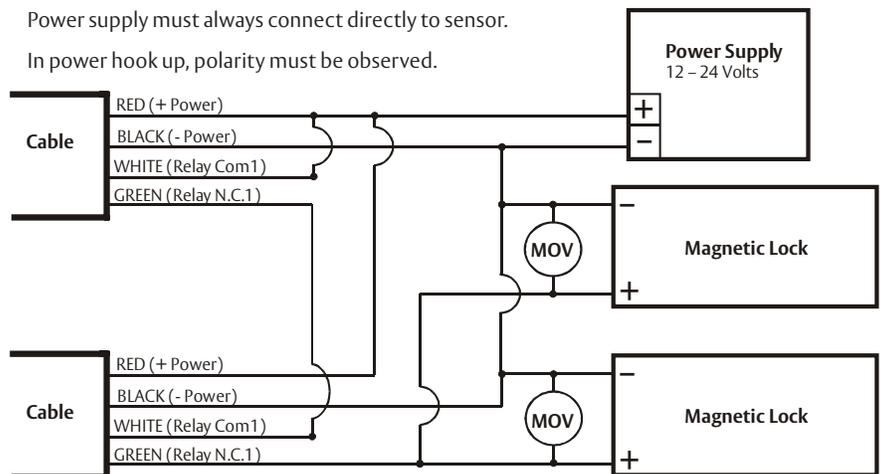
**Diagram 7** Double break wiring
