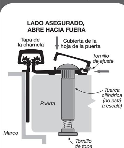
**NOTA:** Para las aplicaciones con abertura hacia dentro, invierta la posición de la tuerca cilíndrica y del tornillo de tope para que del tornillo de tope esté en el lado asegurado de la puerta.
