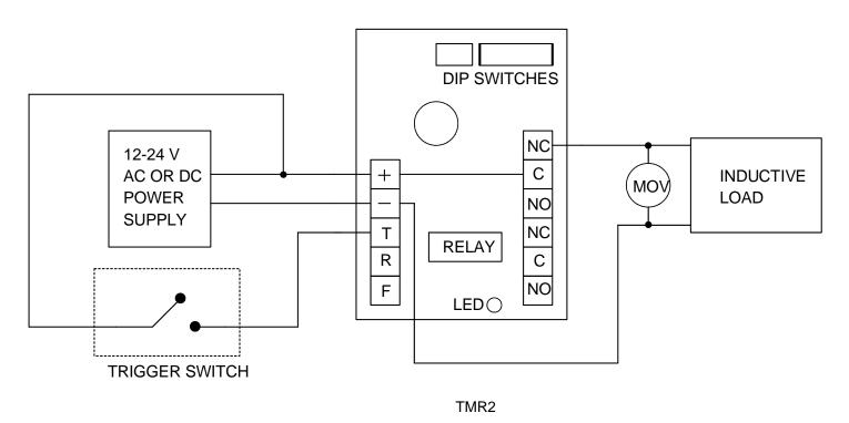
IN THIS CIRCUIT, THE LOAD TURNS OFF WHEN THE TIMEMASTER RELAY ENERGIZES
