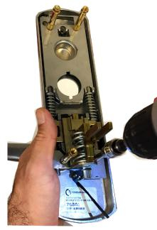
4. TEST SWITCH BY ACTIVATING LEVER UP & DOWN MAKING SURE THE SWITCH CHANGES STATES.
