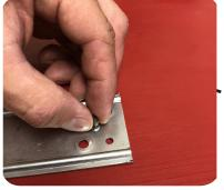
FLIP THE PUSH PAD OVER & REMOVE BOTH SCREWS SECURING THE FRONT PUSH PAD END CAP.
